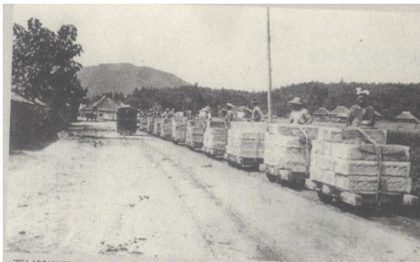
荒針付近の人車軌道貨車 （大町雅美「郷愁の野州鉄道」随想舎より）
